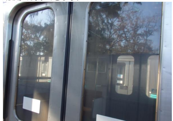
ドア窓ガラスは汚れ曇っている 実際は車内が見えない状態である
